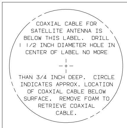
**KEY PART NUMBER** 120431-01-000    **U/M DESCRIPTION** EA LABEL - LOCATION - COAXIAL CABLE/SATELLITE ANTENNA
